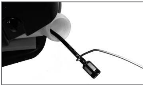
Рис. 11 Обслуживание топливного фильтра
